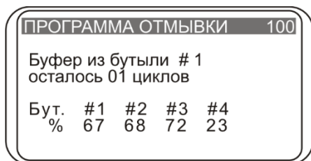
Рисунок 9. Дисплей при работающей программе и с подключённым терминалом контроля объёма жидкости
